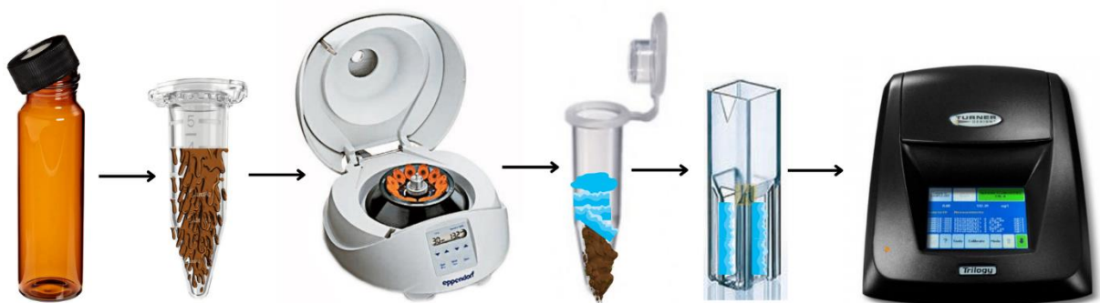
Figura 6: Esquema con resumen del procedimiento llevado a cabo para la determinación de la fluorescencia.
