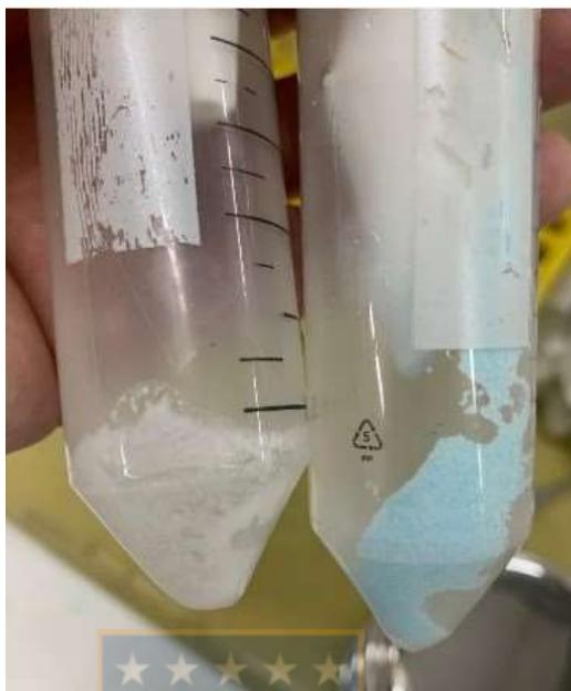
**Figura 4.31** Comparación resina melamina-formaldehído sin H<sub>4</sub>EDTA (izq) y con H<sub>4</sub>EDTA (derecha) después de estar en contacto con soluciones con Cu<sup>+2</sup>.
