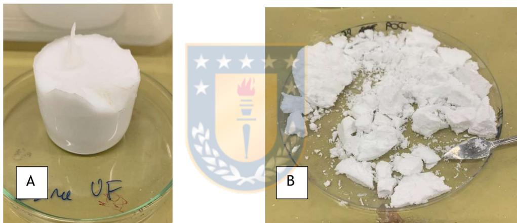
**Figura 3.4.** A -Resina comercial RUF curada con alto grado de entrecruzamiento y (B) con menor grado de entrecruzamiento.
