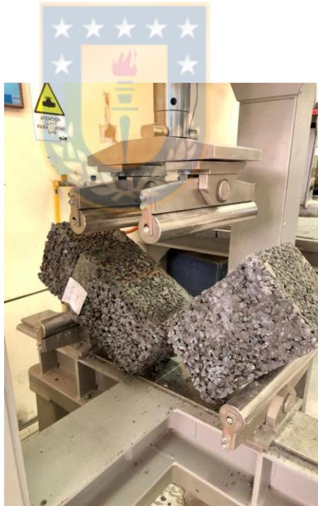
Figura 3.6. Probeta ensayada a resistencia a flexotracción en máquina universal.
