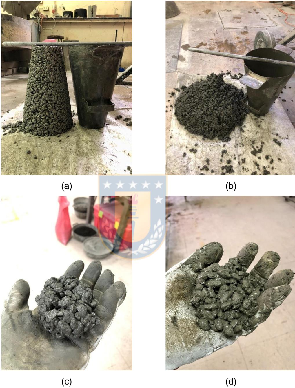
Figura 3.4. Posibles resultados de trabajabilidad: (a) Cono cero; (b) Cono colapsado; (c) Esfera estable; (d) Esfera inestable.
