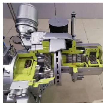
(b) Montaje motores BYD corte.
