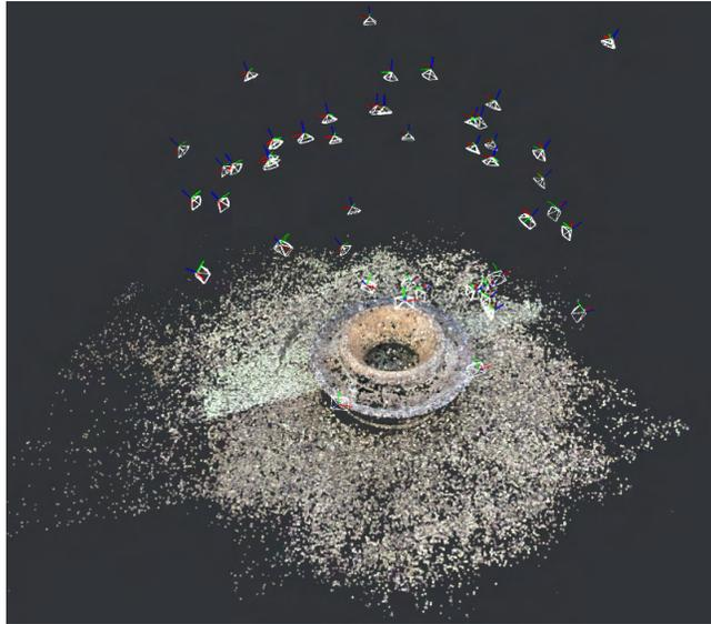
**Figura 4.9.** Captura de pantalla del escaneo 3D de la cóncava con fotogrametría usando Meshroom. Se observa la nube de puntos generada y la posición de las cámaras.
