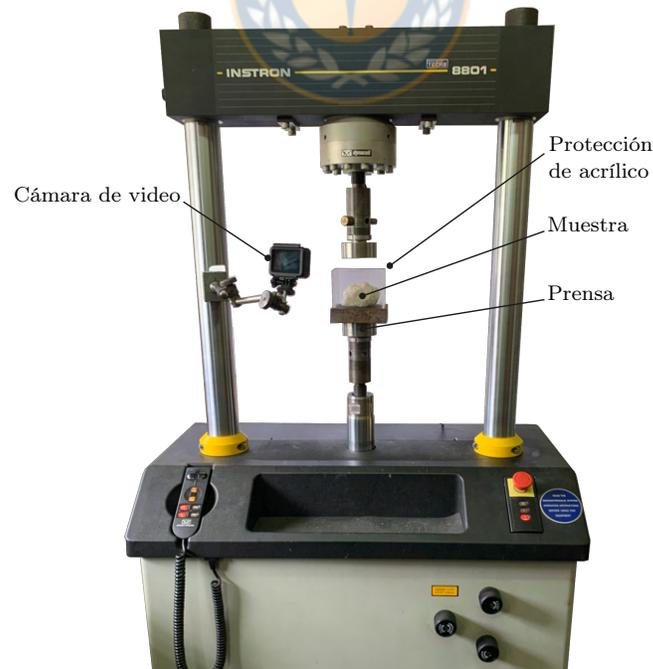
**Figura 4.6.** Montaje experimental para ensayos de compresión uniaxial de partículas irregulares. Se muestra la máquina de ensayos universales Instron 8801 y una muestra de cuarzo en la prensa.
