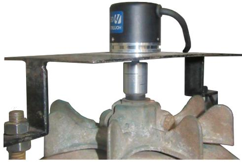
**Figura 4.14.** Encoder Metaltex HTR-3A-2500A-H montado en el motor eléctrico para la medición de velocidad de rotación del eje motriz.
