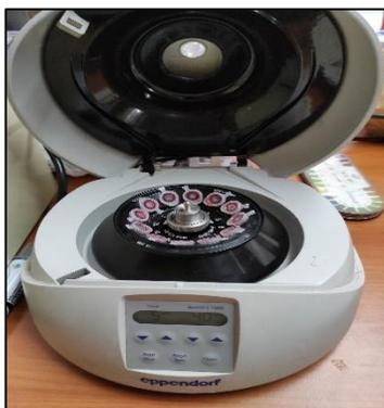
*Figura 6. Centrifuga MiniSpin Eppendorf con las muestras sanguíneas en tubos Eppendorf.*
