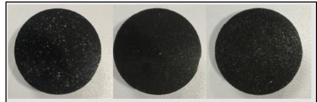
Figura 3. Briquetas de muestras. Cilindros sólidos con un diámetro de 3 cm
