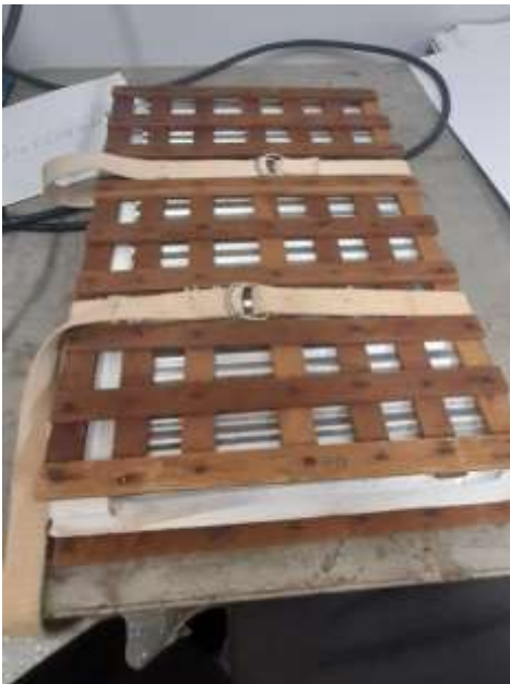
Figura 2. Prensa de Algas de madera; para depositar material recolectado entre varias capas de papel de cartón. Con zinc y madera en superficies inferior y superior, amarrados firmemente con cintas de género para su fijación.
