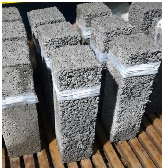
**Figura 3.10** Viguetas de hormigón poroso en sala de curado
