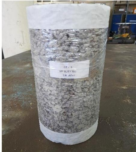
**Figura 3.15** Probeta cilíndrica con recubrimiento lateral de papel alusa y refuerzo en bordes
