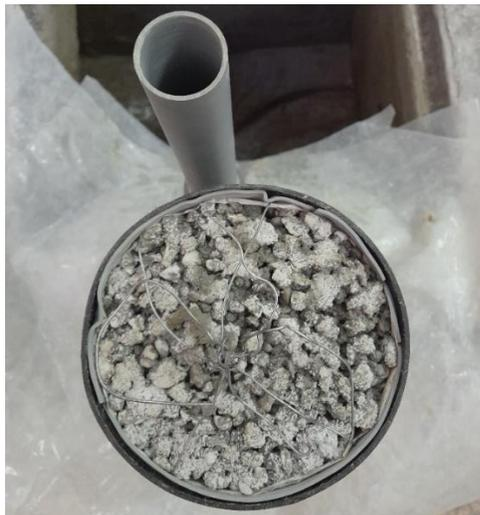
**Figura 3.16** Probeta al interior del permeámetro
