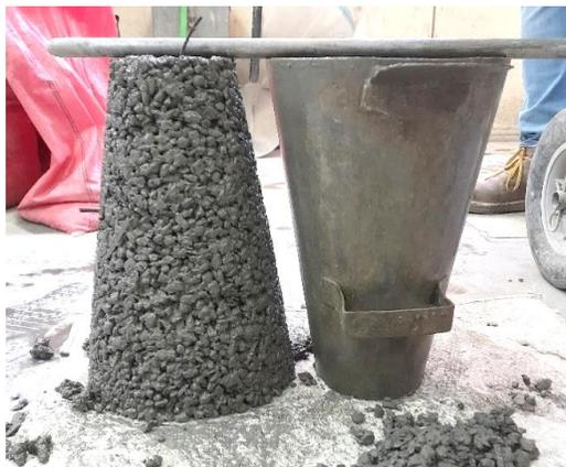
**Figura 3.9 Medición de cono de Abrams**
