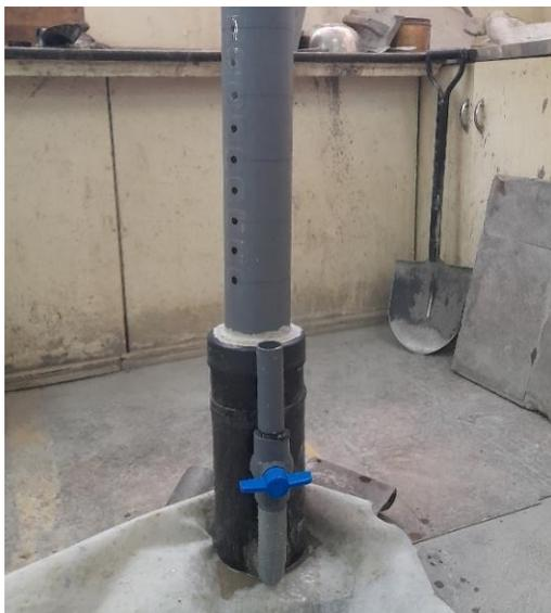
**Figura 3.14 Permeámetro de carga variable**
