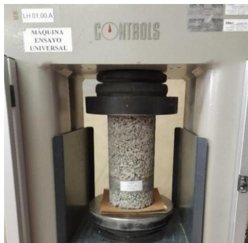
Figura 3.11 Ensayo de resistencia a compresión
