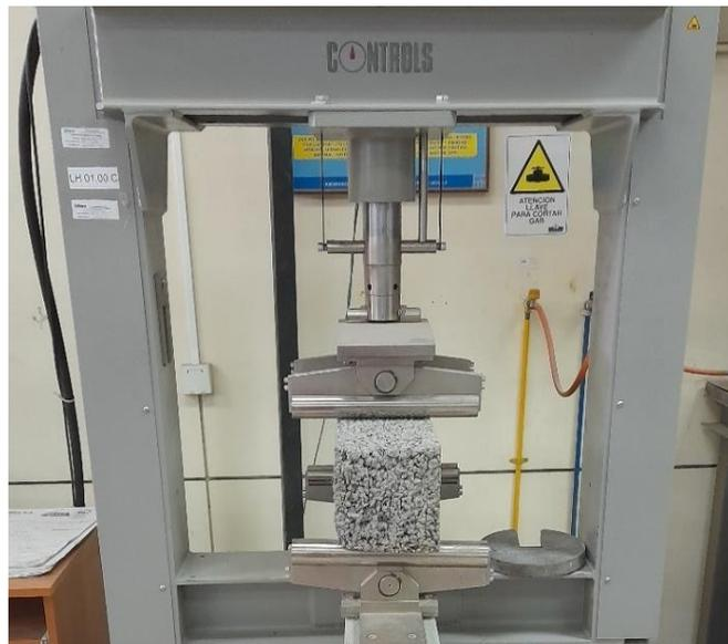
Figura 3.12 Ensayo de resistencia a flexotracción
