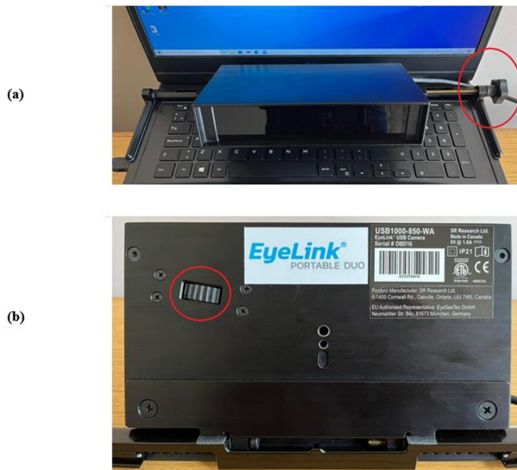
Fig A4. En (a) se ilustra la perilla lateral del ET para configurar el ángulo, y en (b) se observa la perilla inferior que corrige el enfoque del ET.
