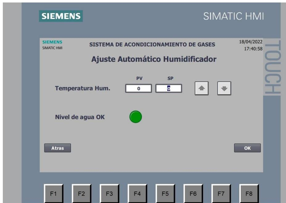
Fig. A7-4 Vista de ajuste automático de humidificador
