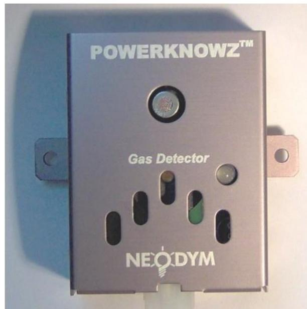
**Fig. 3.11 Sensor de H<sub>2</sub> Neodym de Powerknowz [11]**
