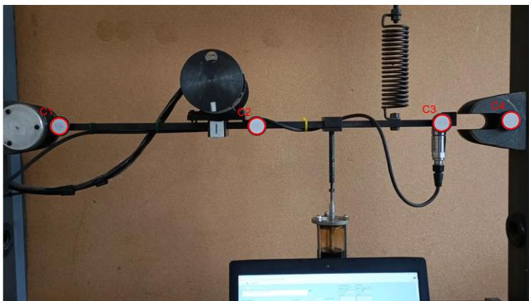
**Figura 21. Velocímetro instalado en la viga.**
