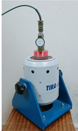
**Figura 38. Generador de vibraciones.**
