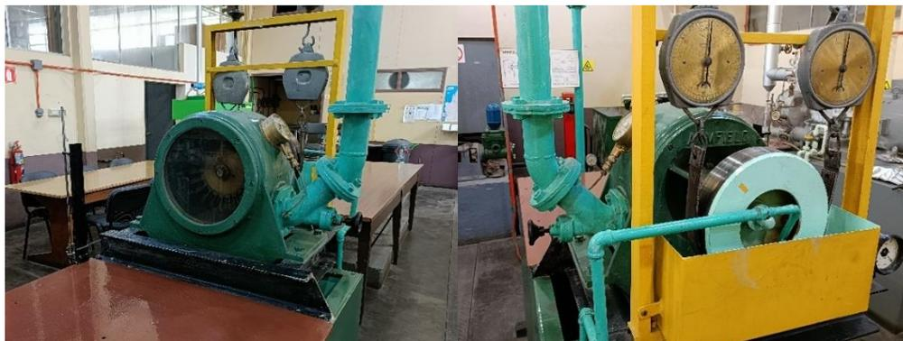
**Figura 14. Turbina hidráulica para medir vibraciones.**
