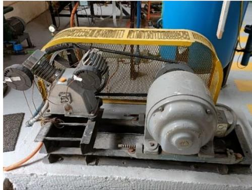
**Figura 13. Conjunto motor-compresor para medir vibraciones.**
