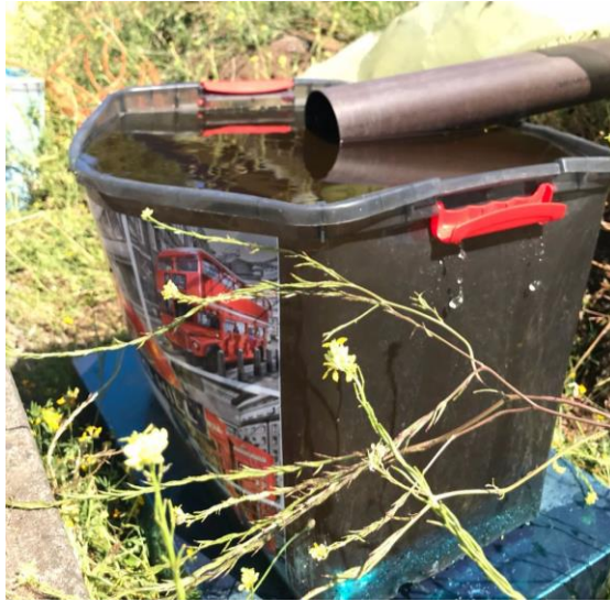
Figura 22.- Pesado de la escorrentía proveniente de la cubierta verde, producto de la precipitación aplicada con el simulador de precipitaciones, en la figura se ilustra la escorrentía generada con una intensidad de 54 mm/hora. Fuente: Elaboración propia.
