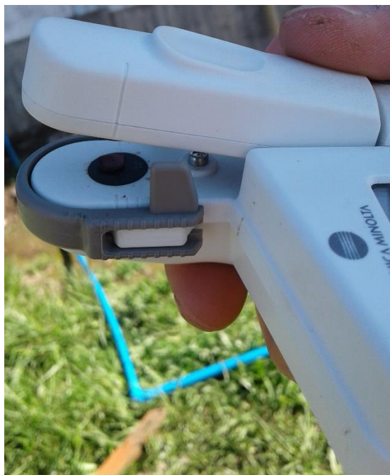
Figura 10.- Medidor portátil de clorofila SPAD-595. Fuente: Elaboración propia.
