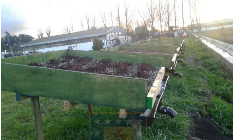
Figura 20.- Módulos de cubierta verde utilizados en el estudio. Fuente: Elaboración propia.
