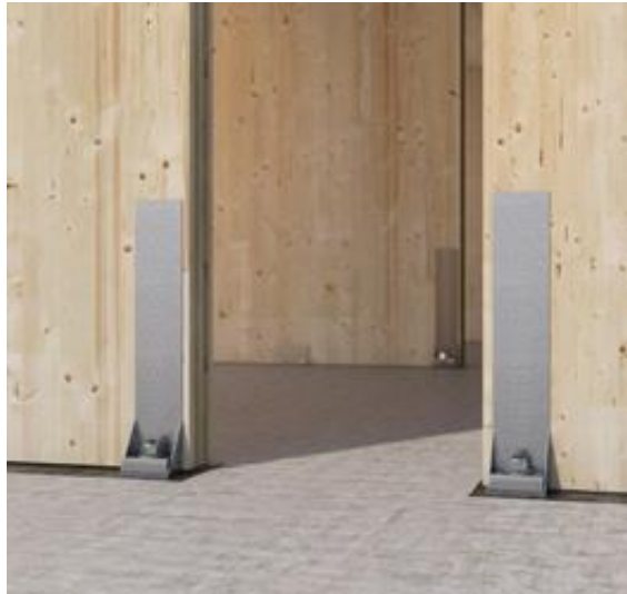
Figura 2.5 Conexión tipo hold-down. (Rothoblass, 2020)
