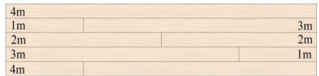
Figura 3.5 Probeta Viga con empalme.
