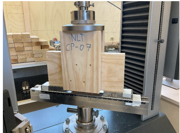
Figura 3.15 Implementación ensayo de compresión en uniones clavadas.
