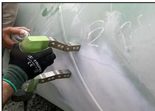
**Figura 11:** Yugo Magnético, ensayo de partículas magnéticas (MT).
