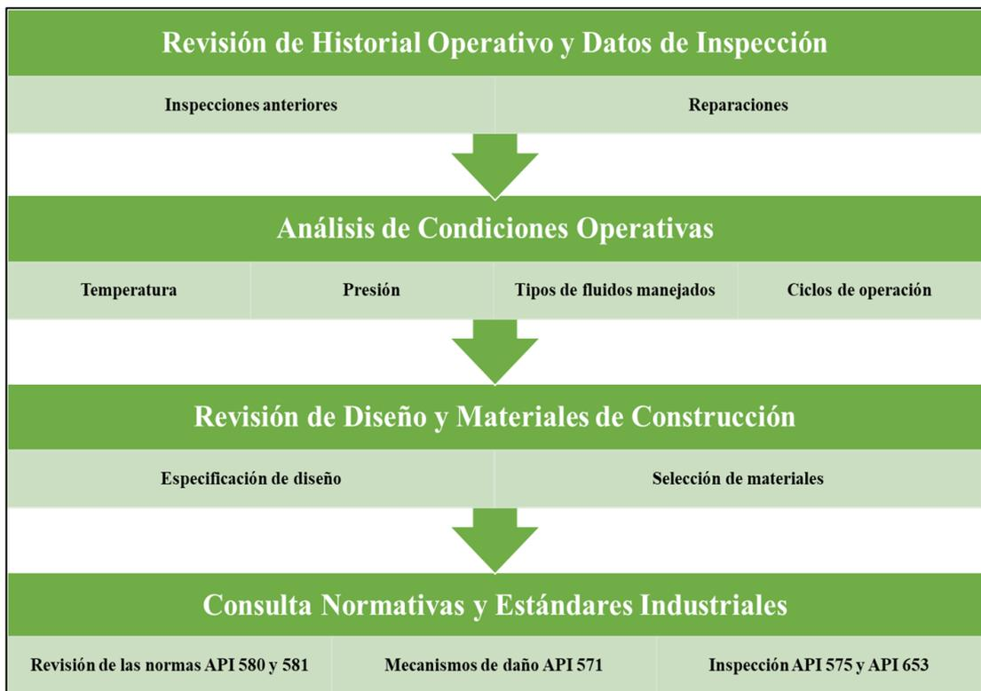
**Figura 8:** Identificación del Mecanismo de daño, elaboración propia según [3]
