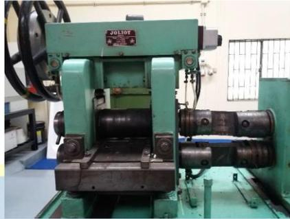
**Figura 13** Laminadora utilizada para la laminación en caliente a 1000°C.
