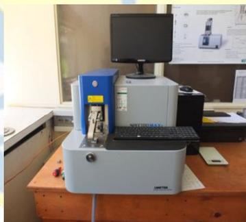
**Figura 10** Equipo de microscopia de emisión óptica
