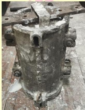
**Figura 8** Molde cilíndrico para fabricar crisoles
