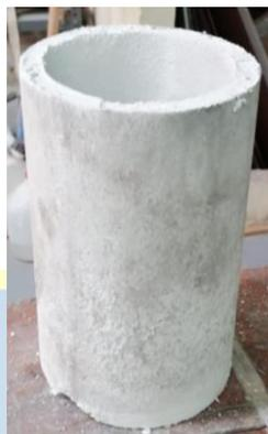
**Figura 9** Crisol de cemento refractario
