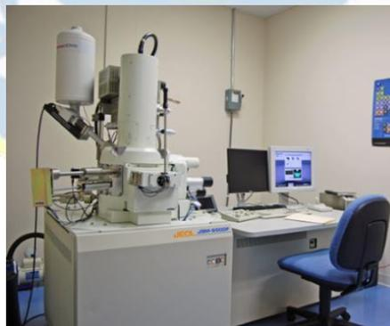
**Figura 17** Microscopio electrónico de barrido JSM-6010plus
