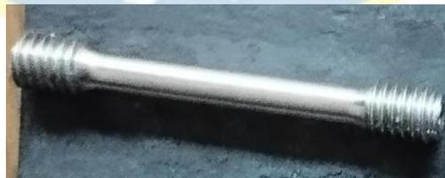
**Figura 18** Probeta DIN diámetro 4 métrico 6 para ensayo de tracción
