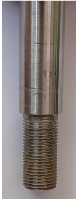
Figura 4.20: Parte expuesta a lechada del eje al finalizar los ensayos.
