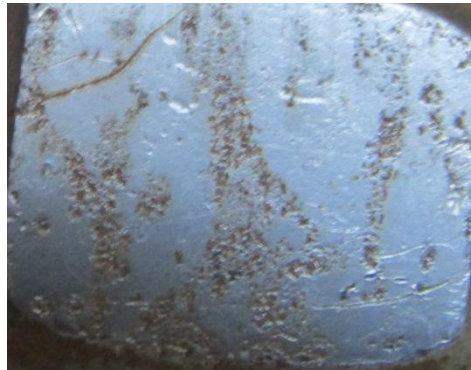
Figura 4.19: Superficie exterior tuerca M16 al finalizar los ensayos.
