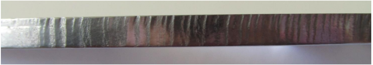
Figura 4.17: Desgaste presentado en los bordes externos de la placa inferior.
