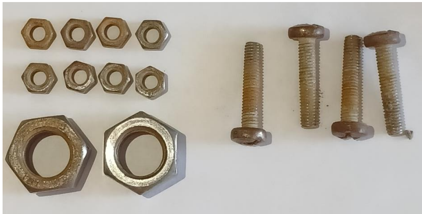
Figura 4.18: Sistemas de acoples al finalizar los ensayos.
