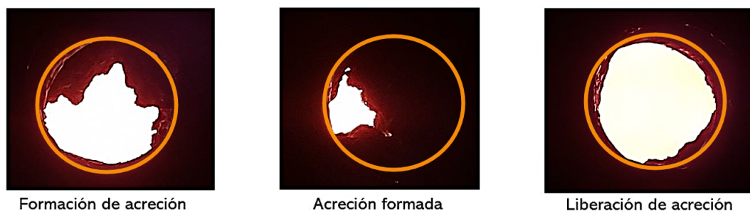
Figura 3.2.3: Ejemplos de visión el quemador central. Imagen izquierda: Corresponde a la etapa de formación de la acreción, en donde aun la irradiancia media no baja el umbral. Imagen central: Corresponde a un momento donde la irradiancia media bajo el umbral, se ha formado la acreción. Imagen derecha: corresponde a un instante en donde la acreción ya se limpio y se tiene toda la visión.
