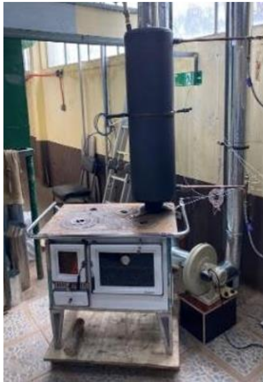
Figura 3.1: Cocina con termo cañón comercial (Fuente: [11])
