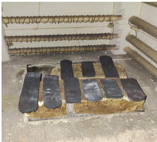
*Figura 16: Piezas después de laminadas en calientes listas para T.T. de solubilización.*
