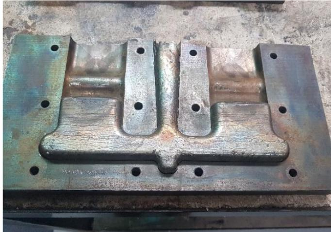
*Figura 12: Aleación solidificada dentro de la lingotera metálica.*
