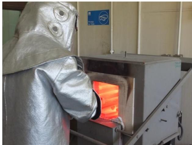
*Figura 13: Horno mufla de Nabertherm.*
