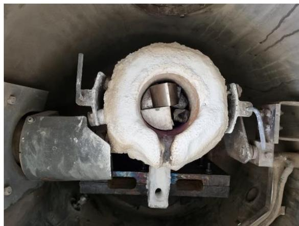
Figura 9: Ferroaleaciones precalentadas dentro del molde para ser fundida.
