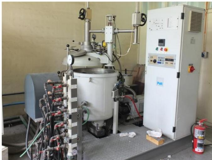
*Figura 11: Horno de inducción con atmosfera controlada (inyección de argón) a 1400°C*
