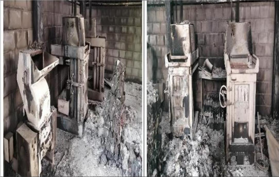
Fotos 17 y 18: Estado de las dos prensas y de la picadora quemadas en galpón de reciclaje
