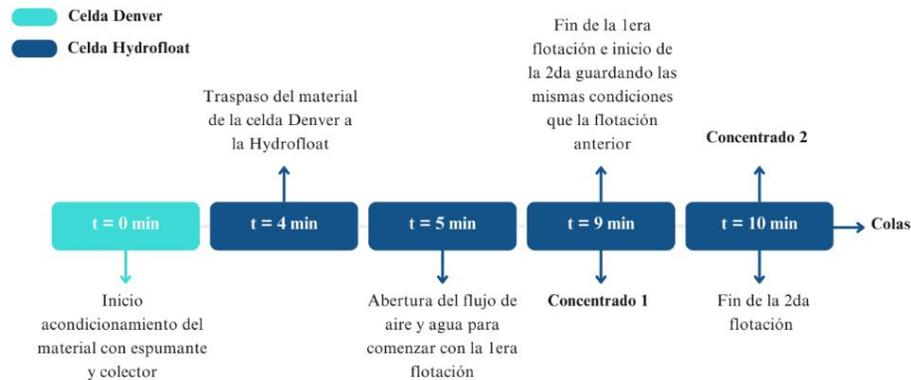
**Figura 35.** Etapas de flotación con sus respectivos tiempos y productos para el ensayo 9.
