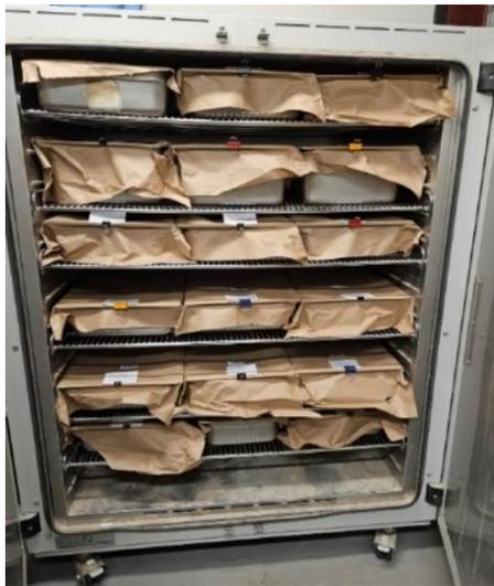
**Figura 20.** Secado de mineral en el horno a 60°C.
