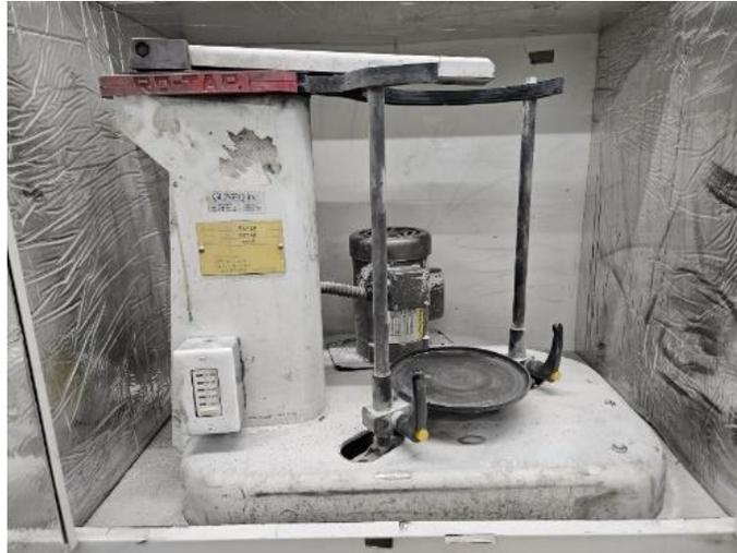
**Figura 27.** Tamizador vibratorio Ro – Tap.
