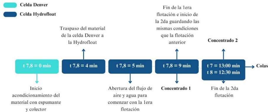
**Figura 33.** Etapas de flotación con sus respectivos tiempos y productos los ensayos 7 y 8.
