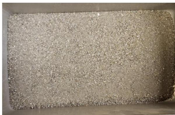
**Figura 30.** Material obtenido del primer chancado 648.96  $\mu\text{m}$ .
