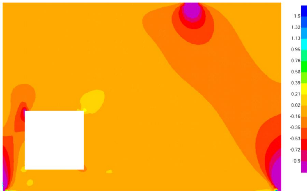
Figura B5. Diagrama de esfuerzos \sigma_{22} para la viga con abertura en kN/mm
