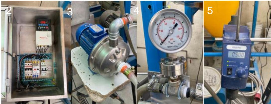
**Figura 16.** Equipo 2 variador de frecuencia ,3 bomba centrífuga,4 manómetro y 5 agitador, respectivamente (Elaboración propia).
