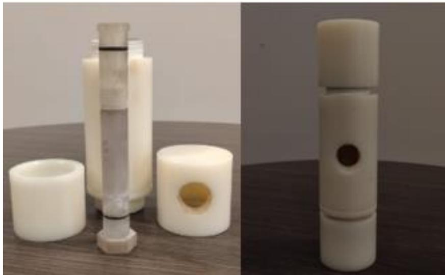
**Figura 10.** Minihidrociclón y carcasa, respectivamente (Elaboración propia).
