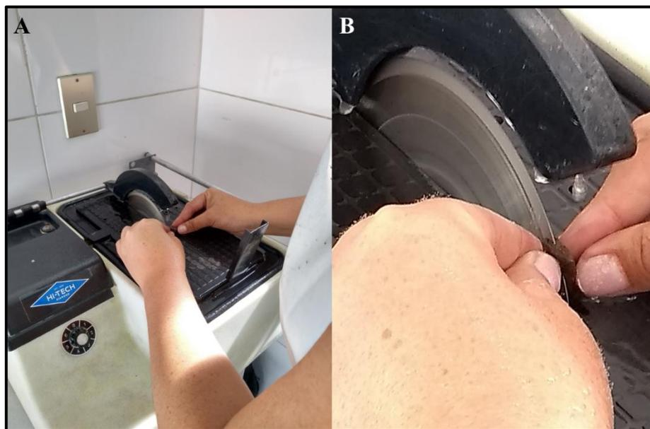
**Figura 1.3:** Preparación de muestras. A) Sierra HI-TEC DIAMOND (laboratorio de rocas, UCh); B) Acercamiento al corte de uno de los condritos ordinarios, procedimiento realizado por la Dra. Millarca Valenzuela.
