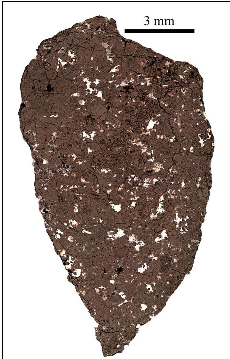
**Figura C.2:** Mosaico de imágenes de la sección pulida del condrito DM-40. Es posible apreciar principalmente la distribución y morfología de los minerales opacos, algunos cóndrulos y fragmentos cristalinos y el fracturamiento de la muestra.
