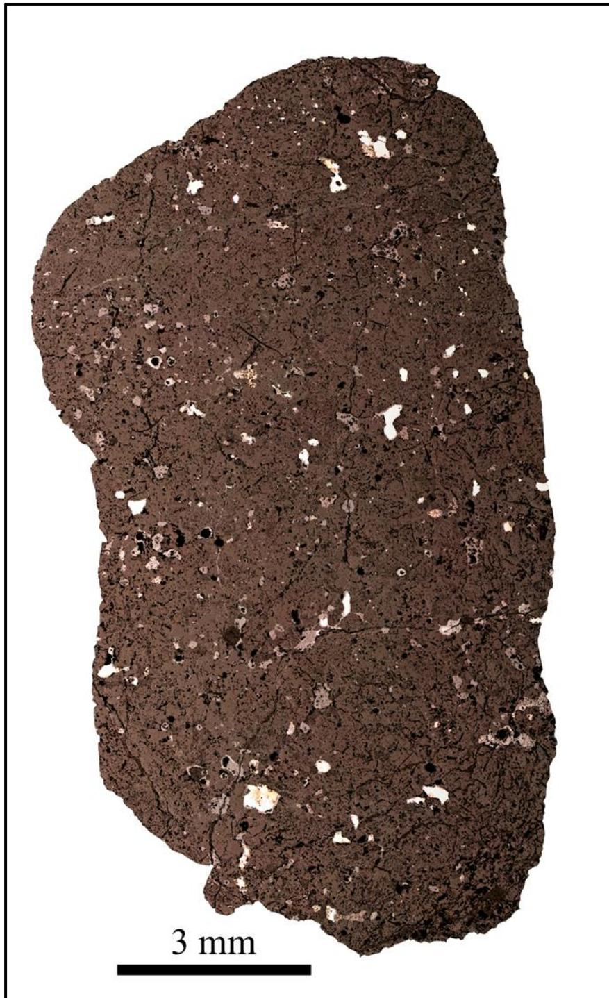
**Figura C.5:** Mosaico de imágenes de la sección pulida del condrito DM-145. Se aprecia la distribución y morfología de los minerales metálicos, así como el desarrollo de la meteorización terrestre sobre ellos.
