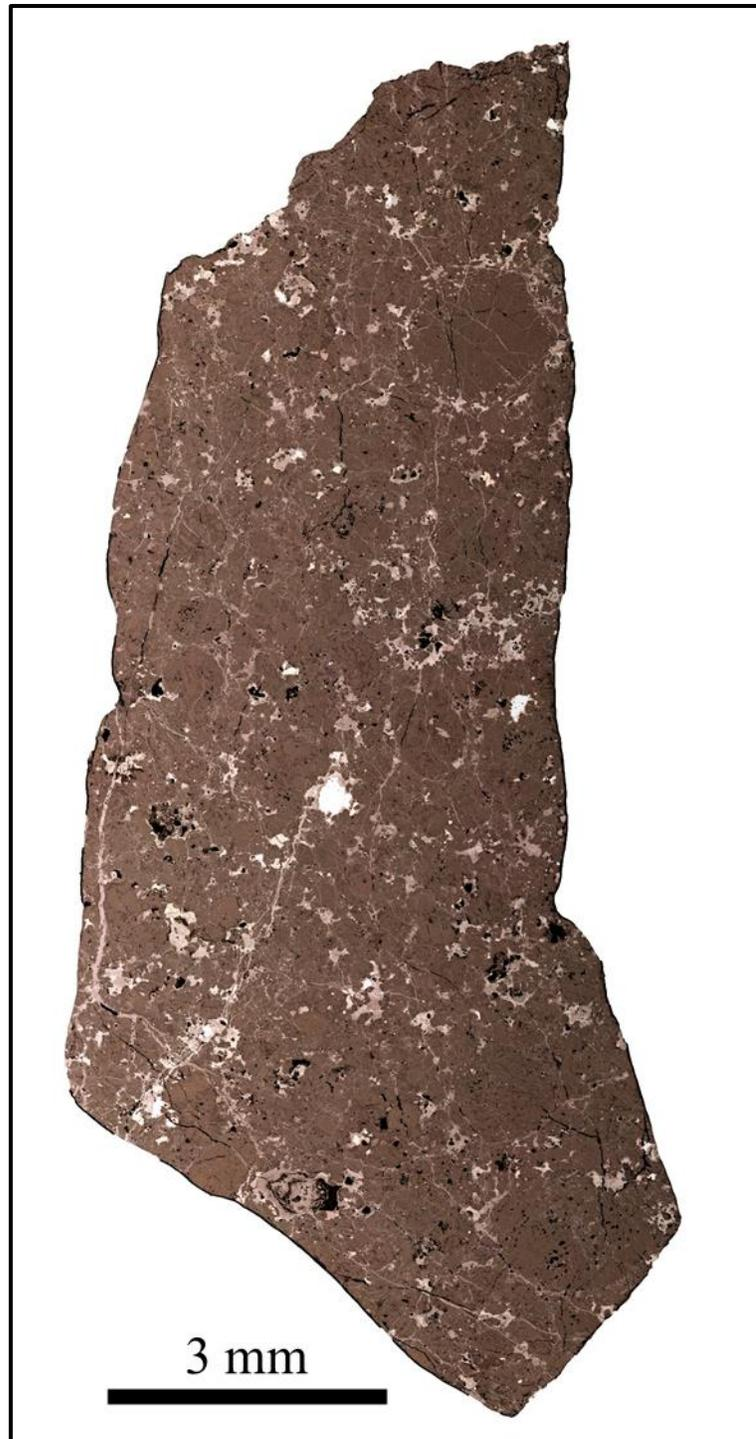
**Figura C.1:** Mosaico de imágenes de la sección pulida del condrito **DM-028**. Es posible apreciar la textura condritica de la muestra, la morfología y disposición de los minerales opacos y la distribución de la porosidad de la muestra.
