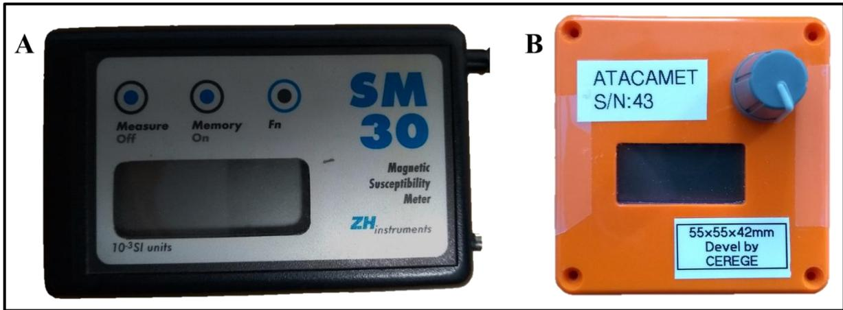
**Figura 1.4:** Dispositivos para la medición de susceptibilidad magnética (susceptómetros). A) SM-30 (ZH instruments); B) ATACAMET (CEREGE).
