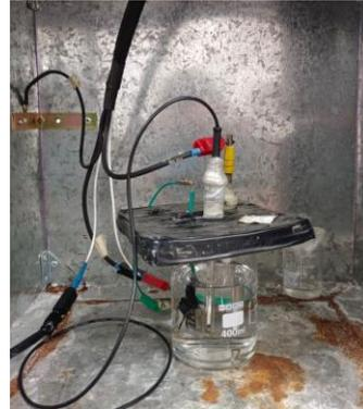
Figura 10: a) Montaje de pieza con resina epoxi b) Montaje de electrodos para ensayos de corrosión.
