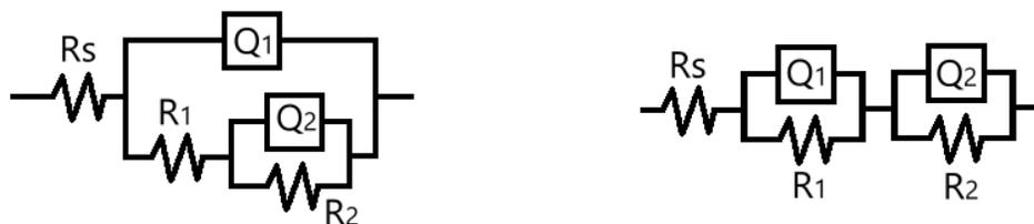
Figura 30: Circuitos de Randles utilizado para el ajuste de curvas.
