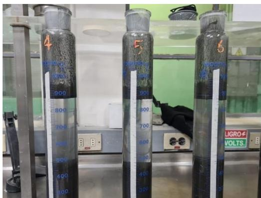
Figura 20. Probetas de sedimentación (Elaboración propia).
