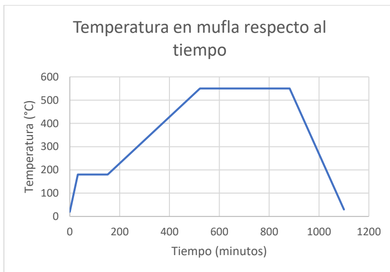
Figura 6.5. Gráfico del perfil de temperatura de la muestra de SBA-15 a calcinar
