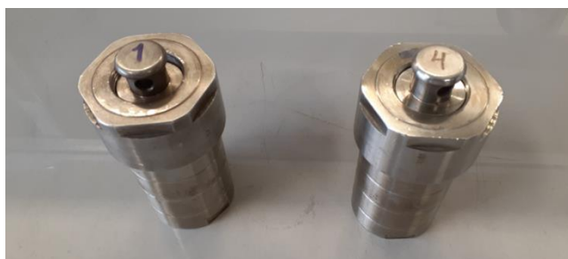
Figura 6.3. Reactores de acero inoxidable sellados
