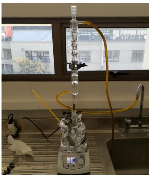
Figura 6.7. Sistema de reflujo, cubierto con papel de aluminio para contener el calor
