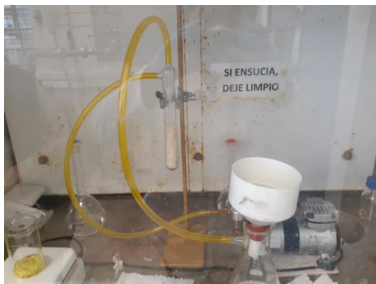
Figura 6.4. Sistema de filtración de vacío, el lecho de arena entre la bomba y el matraz es por seguridad
