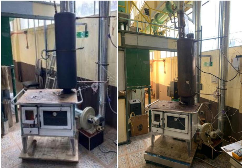
**Figura 4. Banco de ensayos, termocañón comercial a la izquierda y prototipo a la derecha**
