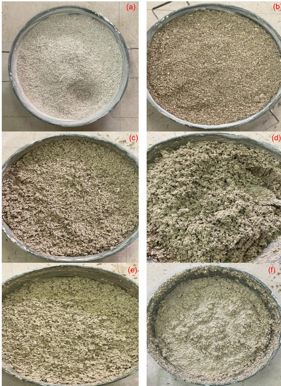
Figura anexo 4.2: registro fotográfico de evaluación de trabajabilidad. (a) muestra seca; (b) 50% de agua; (c) 75% de agua; (d) 100% de agua; (e) 125% de agua extra; (f) 150% de agua extra.
