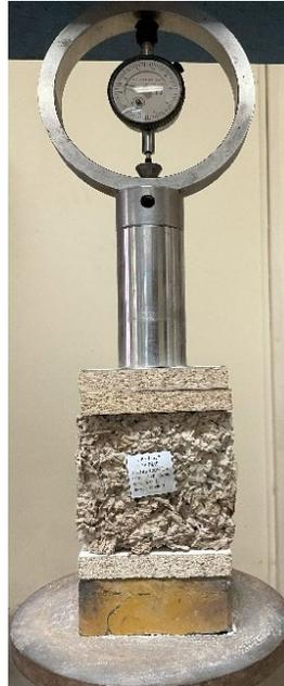
Figura 3.10: Probeta ensayada a resistencia a la compresión
