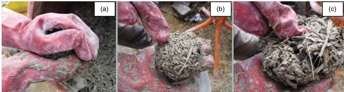
Figura 2.4: Prueba de mezcla, (a) apretar un poco de hempcrete, hasta formar una pelota, (b) presionar con un dedo la pelota, (c) si se parte de forma limpia, la mezcla es óptima. (Fuente: Stanwix & Sparrow, 2014).
