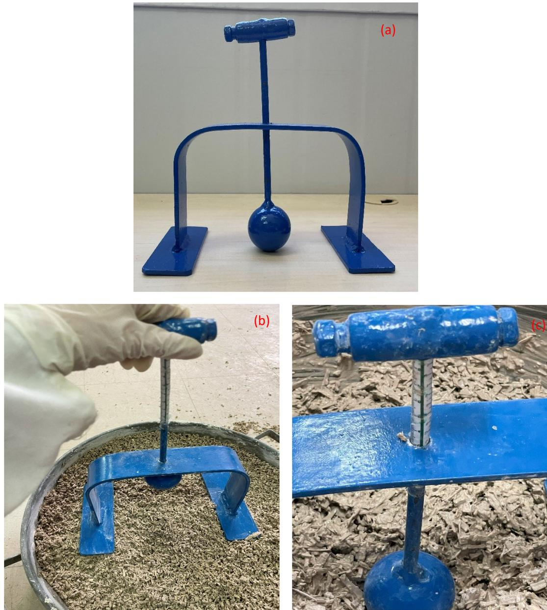
Figura 3.7: (a) Equipo de trabajabilidad; (b) altura de descenso; (c) profundidad de descenso
