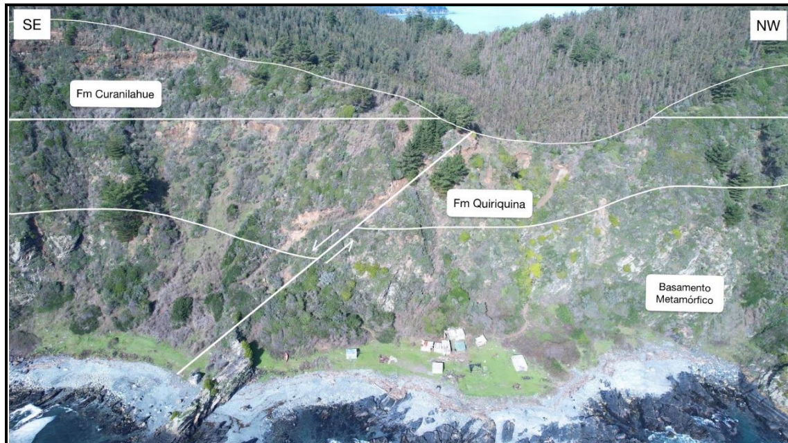
Figura 22: Falla normal del sector NE de punta del Arco, la cual no afectaría a la Formación Curanilahue.
