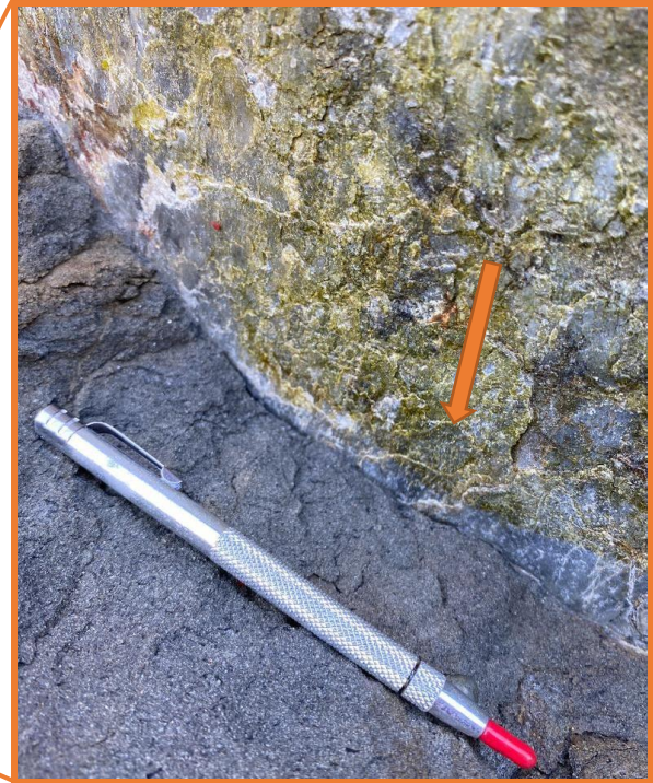
Figura 28: Estrías de falla. La dirección de la flecha marca la orientación de las estrías y relleno mineral posterior al fallamiento.
