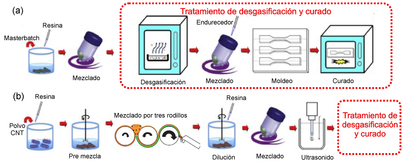
Figura 1.6: Esquema de fabricación de nanocompuestos Epoxi/CNT [20]. (a) A partir de un masterbatch, (b) A partir de CNTs en polvo.
