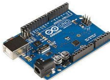
Figura 3.9: Arduino usado como Tarjeta de Adquisición de datos
