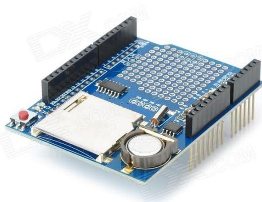
Figura 3.10 Módulo Data Logger
