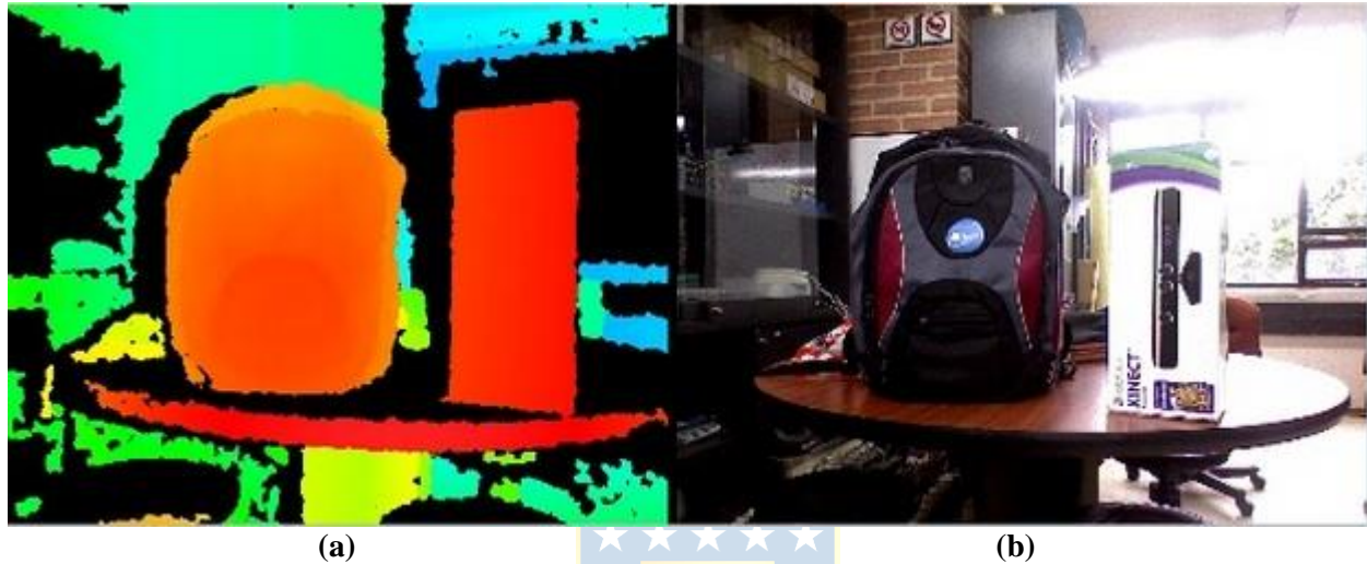
Fig. 2.4 Imágenes Kinect [28] (a) Imagen de disparidad; (b) Imagen RGB
