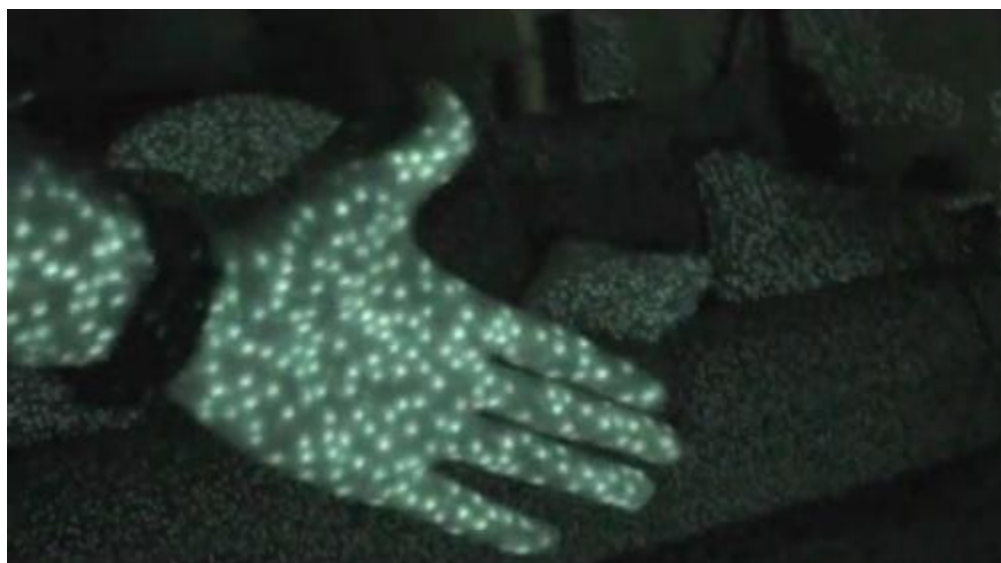
Fig. 2.3Ejemplo de patrón de puntos proyectado [28]
