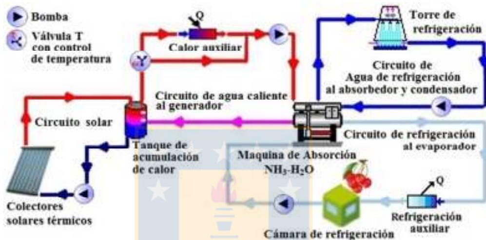
**Figura 7.1.** Esquema del sistema de refrigeración solar por absorción en serie simulado.
