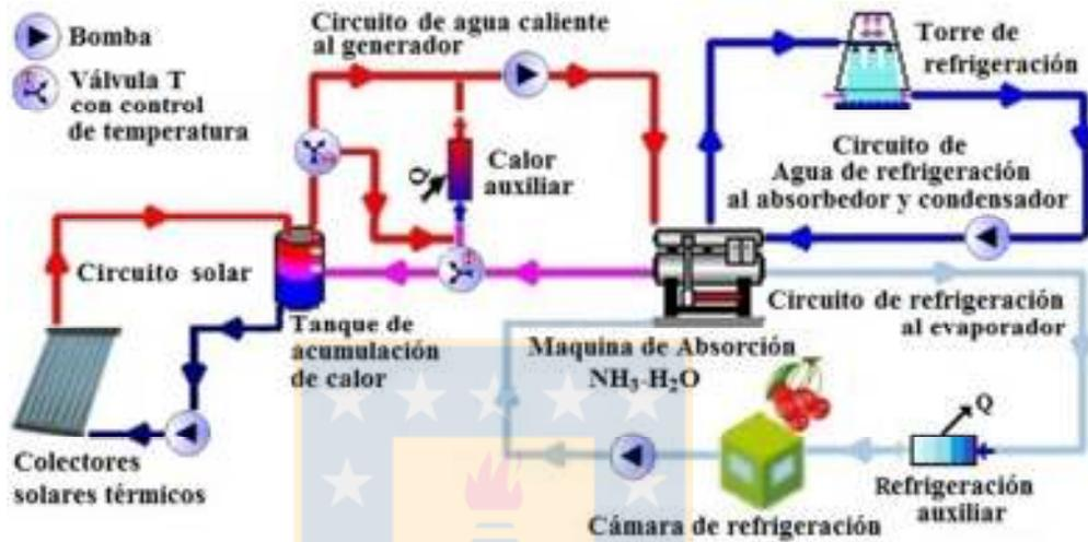
**Figura 7.2.** Esquema del sistema de refrigeración solar por absorción en serie-paralelo simulado.
