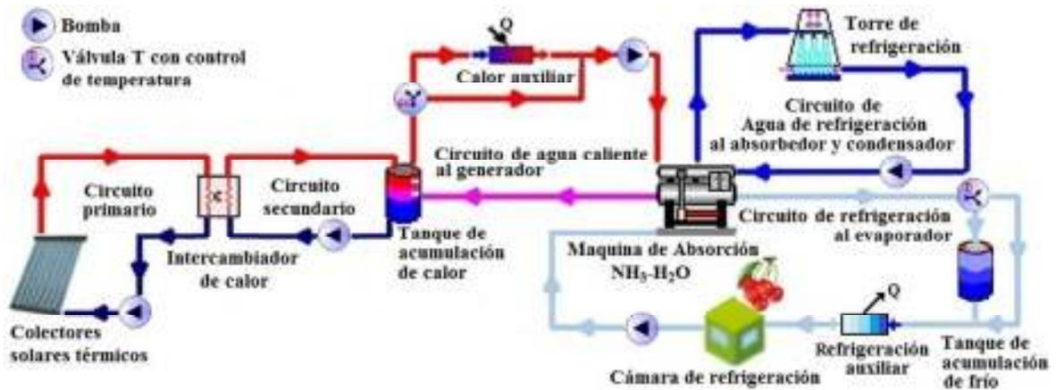
**Figura 3.4.** Sistema de refrigeración solar térmico por absorción con el calor auxiliar en serie al tanque de acumulación de agua caliente.
