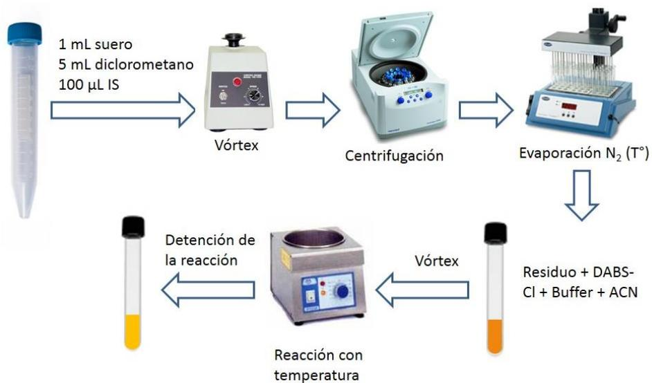
Figura N°2: Esquema de la extracción y derivatización para Topiramato con cloruro de dabsilo como agente derivatizante.
