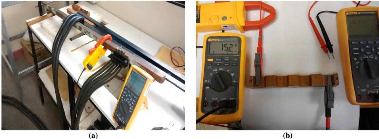
Figura 55. Setup de medición de conductividad de piezas de cobre (a) Pieza M1 C18200 (b) Pieza M2 C11000.
