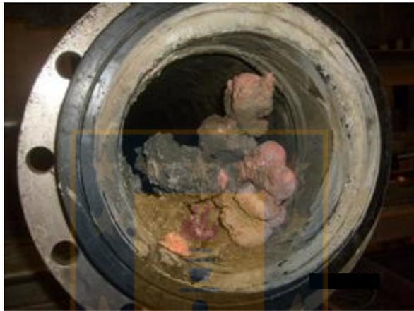
**Figura 59. Depósito de cobre en cañerías de ingreso de electrolito.**
