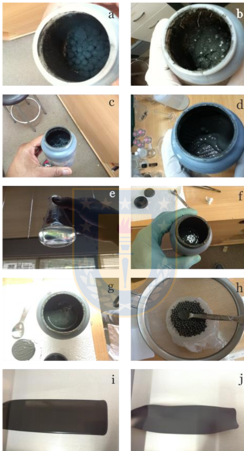
Figura 5.11. Etapas del proceso del moldeo en cinta con polvos precursores de NiO-GDC en a) Resultado de la dispersión inicial por molinda sin sacudidos, b) Resultado de la dispersión apoyada con técnica “jarra coctelera”, c) Resultado de frecuentes y espontáneos sacudidos + molino de bolas, d) Resultado a cabo de las 18 horas de molinda, e) Adición de la solución
