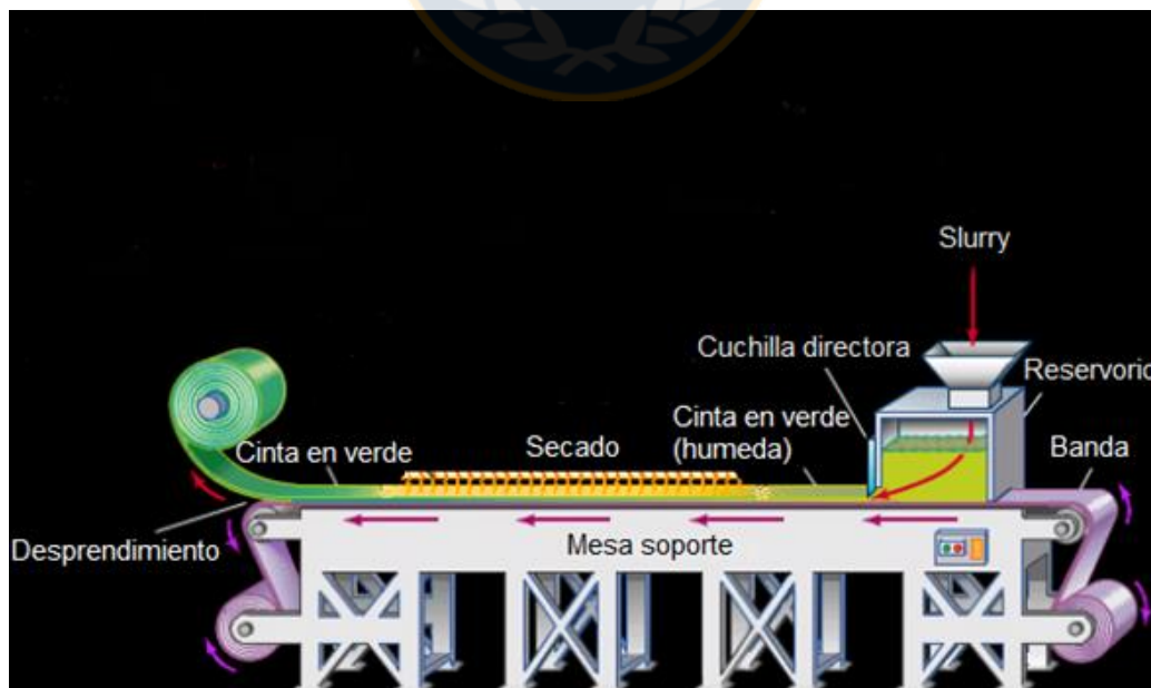
Figura 4.31. Esquematización de un proceso de moldeo en cinta (Fuente: Elaboración propia).
