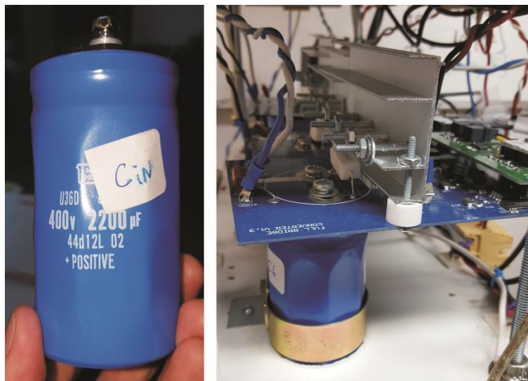
Figura 5.7: Fotografías del enlace DC de un puente-H y el montaje en el chasis del convertidor.
