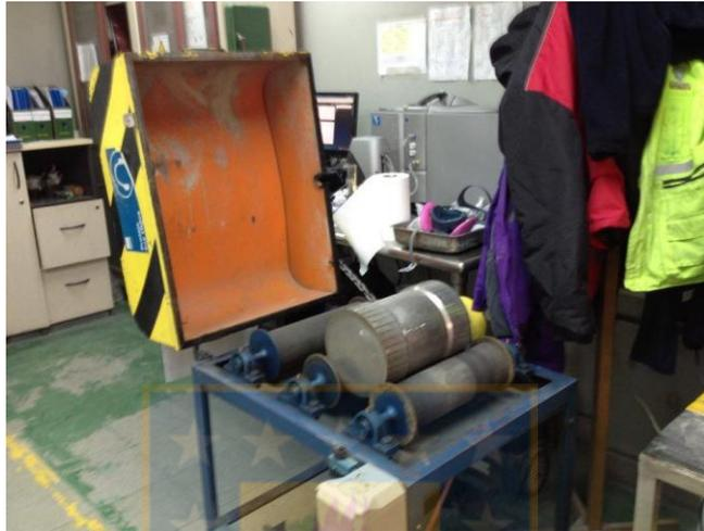
Figura 3.1. Equipo de molienda laboratorio.
