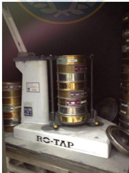
Figura 3.2. Equipo Ro-tap con tamices.
