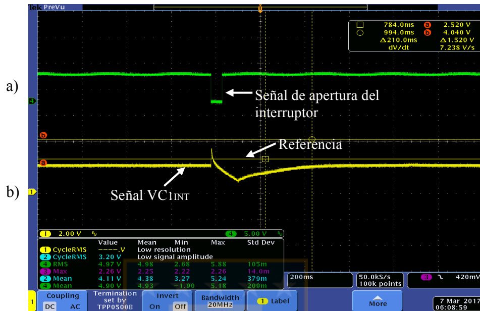
Figura 6.29.- Formas de onda obtenidas de los circuitos implementados, a) Señal de apertura en el circuito secundario. b) Voltaje V_{C1INT} en el circuito primario. Fuente: Elaboración propia.
