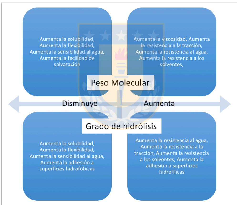
Figura 6. Efecto del peso molecular y el grado de hidrólisis en las propiedades del PVA (Tang and Alavi, 2011)
