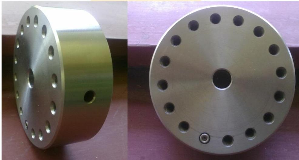
Figura 6.7. Vista de un disco construido para el rotor flexible.
