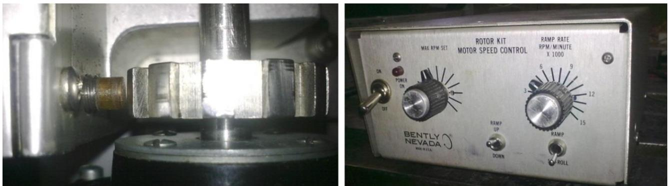
Figura 6.8. a) Sensor de desplazamiento, rueda ranurada b) Controlador de velocidad.
