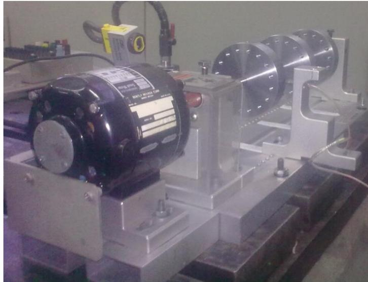
Figura 6.6. Montaje del rotor flexible para la experimentación.
