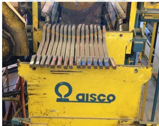
Figura 11.- Ánodos con orejas chuecas.
