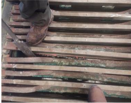
Figura 12.- Ánodos en celdas con orejas chuecas.
