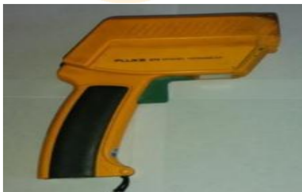
Figura 27.- Termómetro laser para mediciones de temperaturas de contacto.
