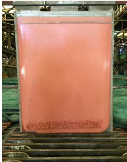
Figura 15.- Nódulos en la zona inferior del cátodo.
