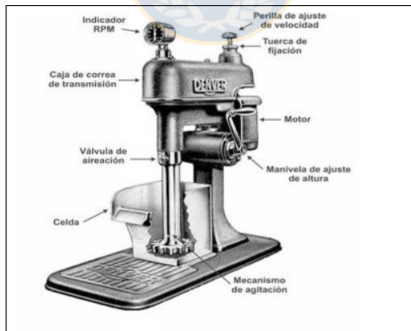
Figura 22. Detalles de la celda de flotación Denver.
