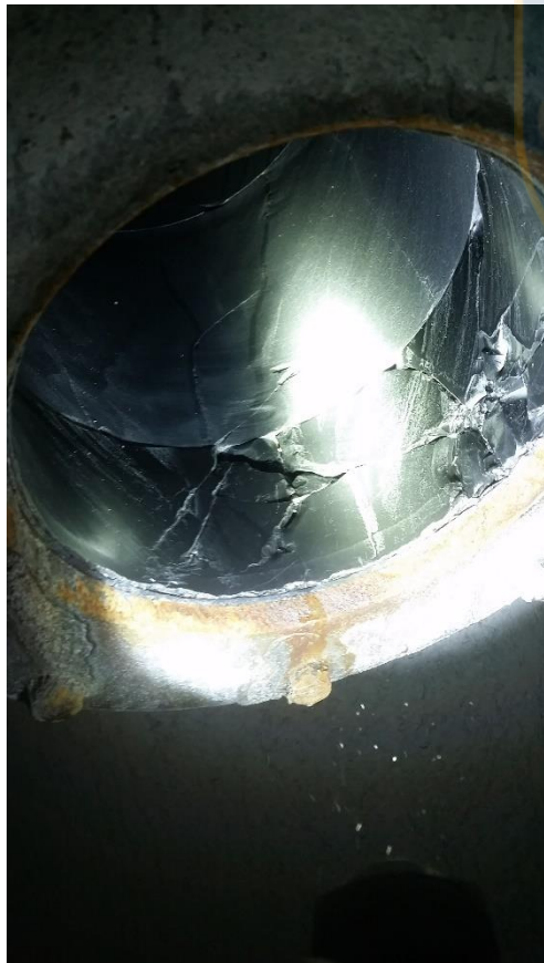
Figura 4.15 Hidrociclón con ápex quebrado y resalte
