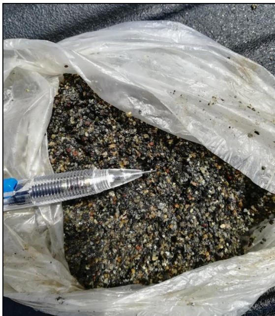
Fotografía 7.2. Muestra de arena gruesa recuperada a los 70 m de profundidad.
