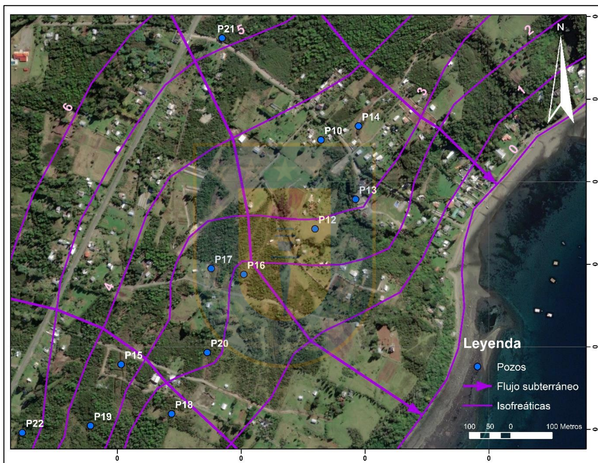
Figura 7.12. Mapa de curvas isofreáticas para el sector propuesto. Las curvas se encuentran trazadas cada 1 metro. Con flechas de color violeta se encuentra trazada la dirección y sentido de flujo subterráneo.
