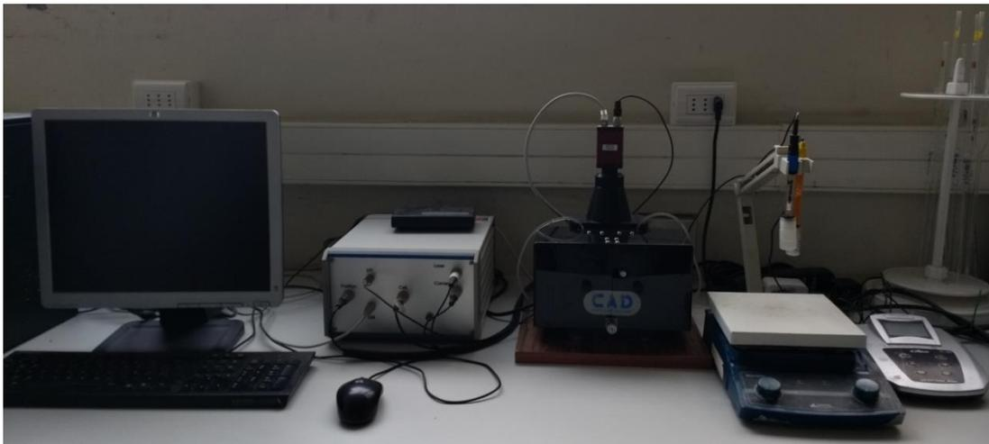
Figura 17. Estación de trabajo, computador, ZetaCompact 9000, agitador y pH-metro.
