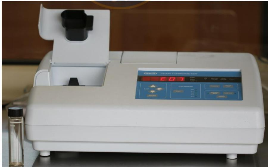
Figura 16. Turbidímetro HACH-2100N junto a recipiente de muestra.
