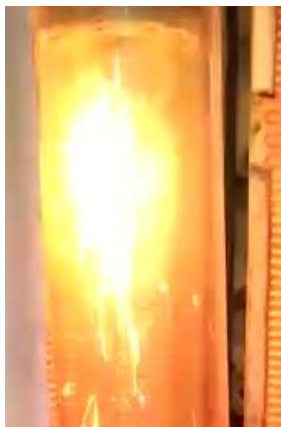
Figura 34 Fusión flash en tubo de cuarzo (Elaboración propia)
